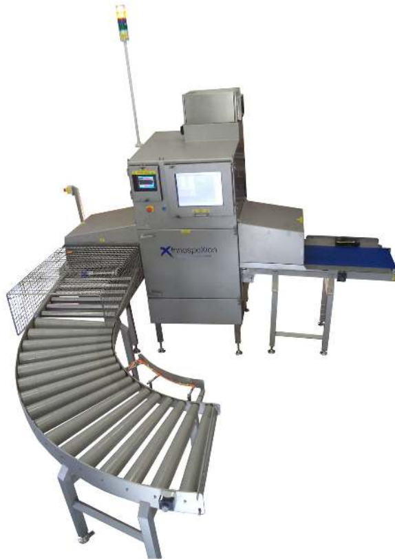
Fig. 1. InnospeXion's nye røntgensystem til store produkter og pakker ses her integreret med en rejktbane for afvigende produkter. Systemet tillader detektion af afvigelser ned til 0.2 mm, og kan leveres integreret med produktionslinjen, for eksempel vedrørende kontrol og overvågning. Systemet retter sig mod u-emballerede produkter, pakker, sække, bloke, m.v., er fødevaregodkendt og bygget efter EHEDG's anbefalinger.
